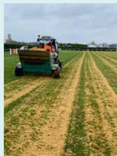
► Réalisation sablage des 2 terrains de foot
